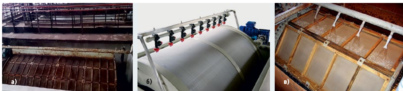
Рис. 2. Общий вид микрофильтра со стальной (а, б) и напроновой сеткой (в)
