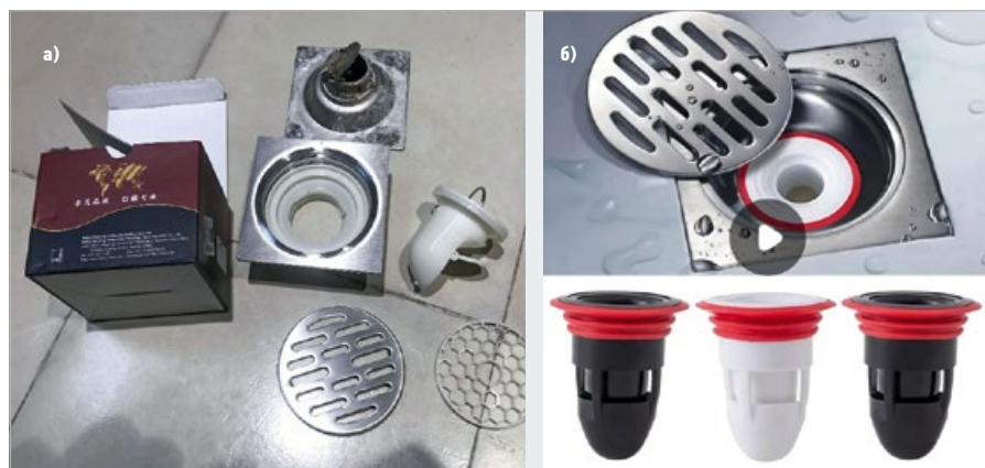
:: Фото 2. Новая сливная вставка с воздушным затвором и магнитной заслонкой [сверху показана старая сливная вставка с воздушным затвором в открытом состоянии из-за коррозии] (а). Вставки с водяным затвором для слива в полу или душе (б)
