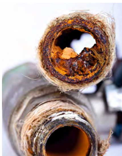
:: Рис. 6. Примеры подвижного и неподвижного осадков в трубах системы ГВС (а — подвижный осадок в большей мере локализуется в лотковой части трубы Ду = 1"; б — неподвижный осадок, вызванный коррозией цинкового покрытия и стальной основы трубы Ду = 3/4", осадок практически равномерно распределён по внутренней поверхности трубы)
