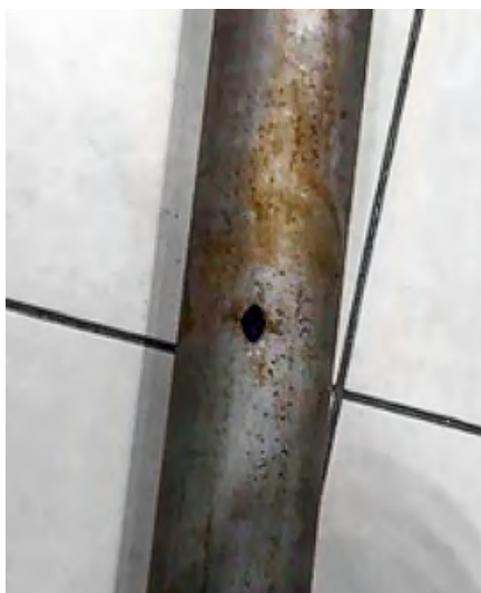
:: Рис. 5. Фрагмент замыкающего участка Ду15 со свищем диаметром 4 мм
