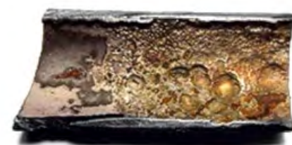
:: Рис. 7. Фрагмент оцинкованной трубы Ду20, изъятый из системы ГВС (а — сторона с продуктами коррозии; б — поверхность трубы после травления 10%-м раствором лимонной кислоты)
