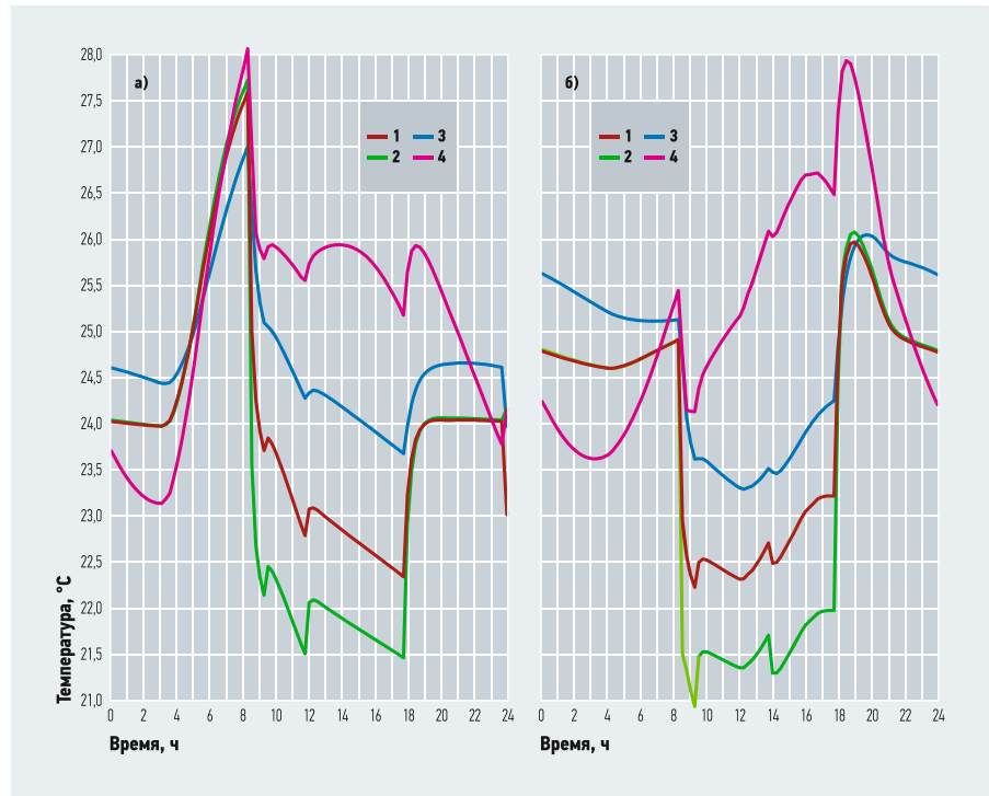
Рис. 2. Суточный ход температур в помещении (а — обращённом на восток, б — обращённом на запад; 1 — результирующая температура помещения; 2 — температура воздуха помещения; 3 — температура внутренней поверхности наружной стены; 4 — температура внутренней поверхности окна)
