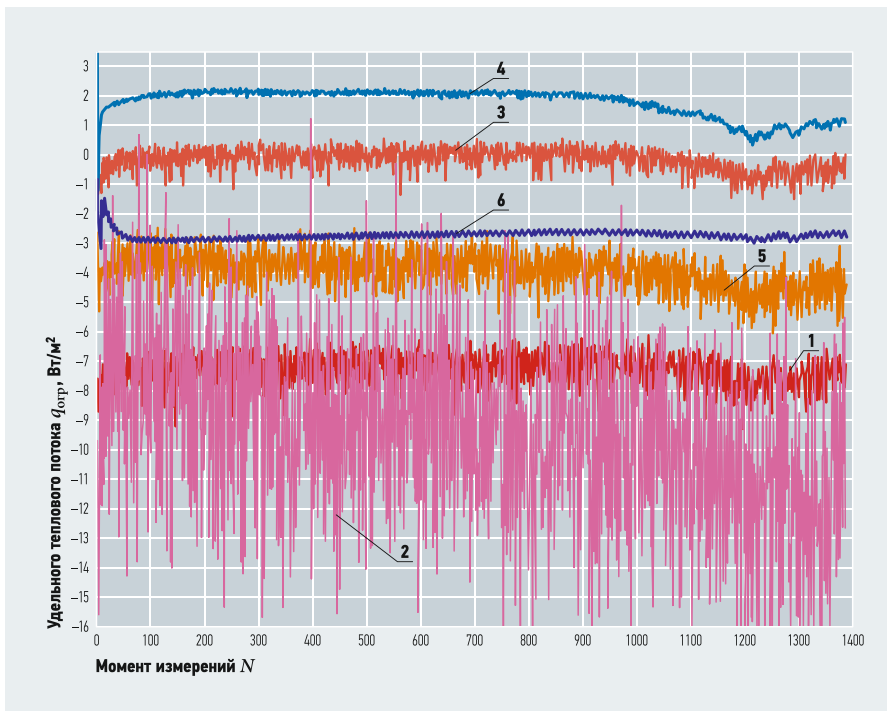
Рис. 2. Результаты замеров удельного теплового потока q_{отр} в точках замера 1–6 согласно рис. 1 для каждого момента измерений
