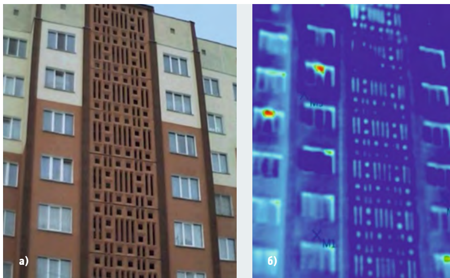
Рис. 2. Жилое панельное здание после утепления (а) и его термограмма (б)
