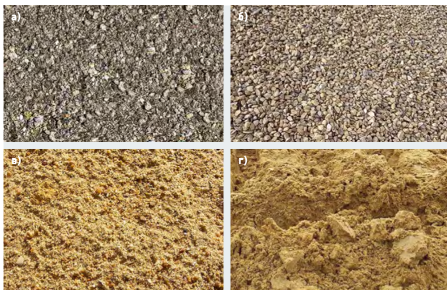
Рис. 2. Типы грунтов (а — скальный грунт, б — крупный, средний и мелкий гравий, в — крупно- и мелкозернистый песок, г — глина)
