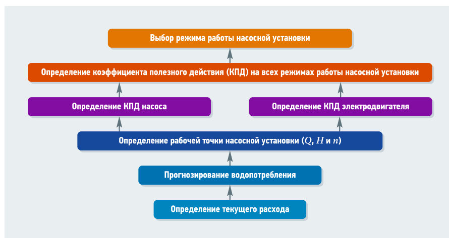
Рис. 1. Алгоритм выбора оптимального режима работы насосной установки
