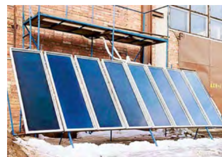
Рис. 3. Экспериментальная всесезонная установка ГВС, установленная в ЦАГИ
