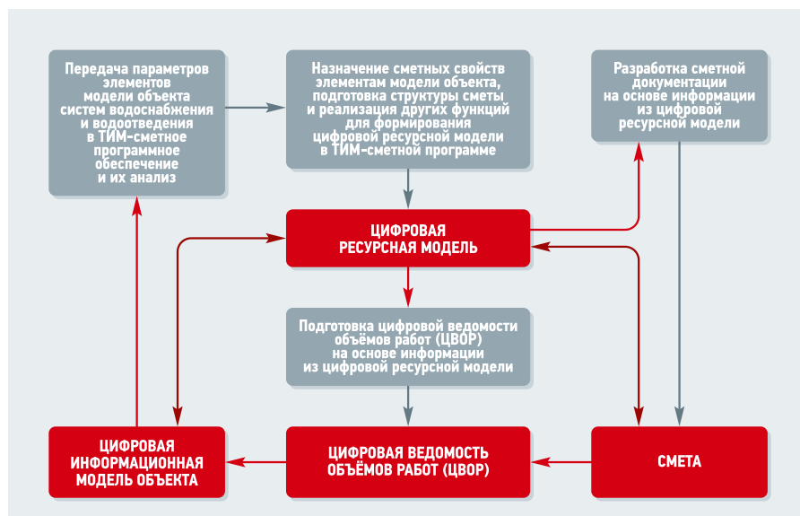
❖ Рис. 1. Схема формирования ведомости объёмов работ и сметной документации с использованием технологий информационного моделирования в инфраструктурном строительстве
