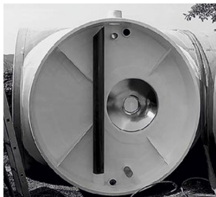
✶✶ Рис. 1. Непроницаемая перегородка: вид на блок-модуль снаружи (слева) и изнутри
