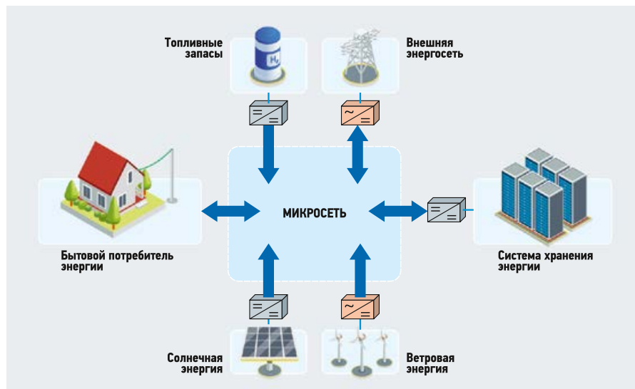
Рис. 1. Принципиальная схема микросети (microgrid)
