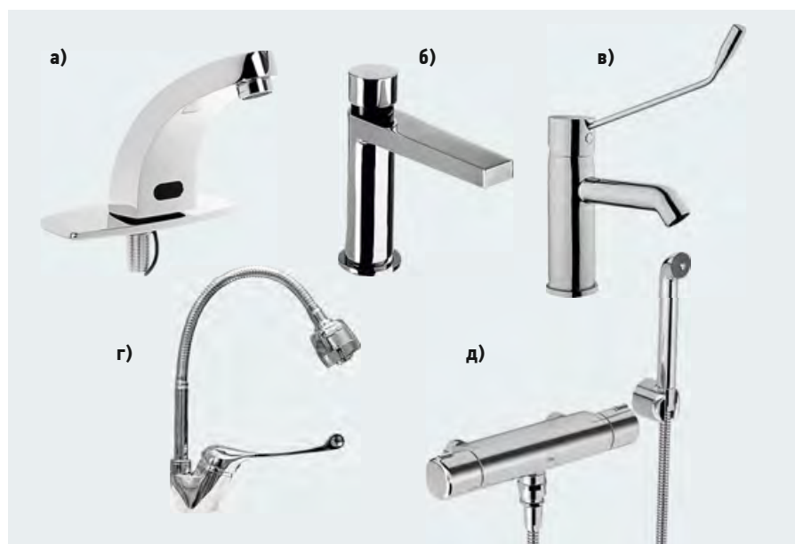
•• Рис. 3. Смесители различных типов для установки в зданиях медицинских организаций [а — сенсорный термостатический напольный; б — нажимной (полуавтоматический) напольный; в — локтевой (хирургический) напольный; г — высокий с гибким изливом, локтевой, напольный; д — термостатический настенный с душем-лейкой; е — настенный локтевой (хирургический)]
