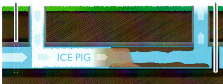
Рис. 2. Схематичное изображение процесса ледяной чистки трубопровода (Ice Pig) на участке, ограниченном двумя колодцами с перекрытием потока шиберами
