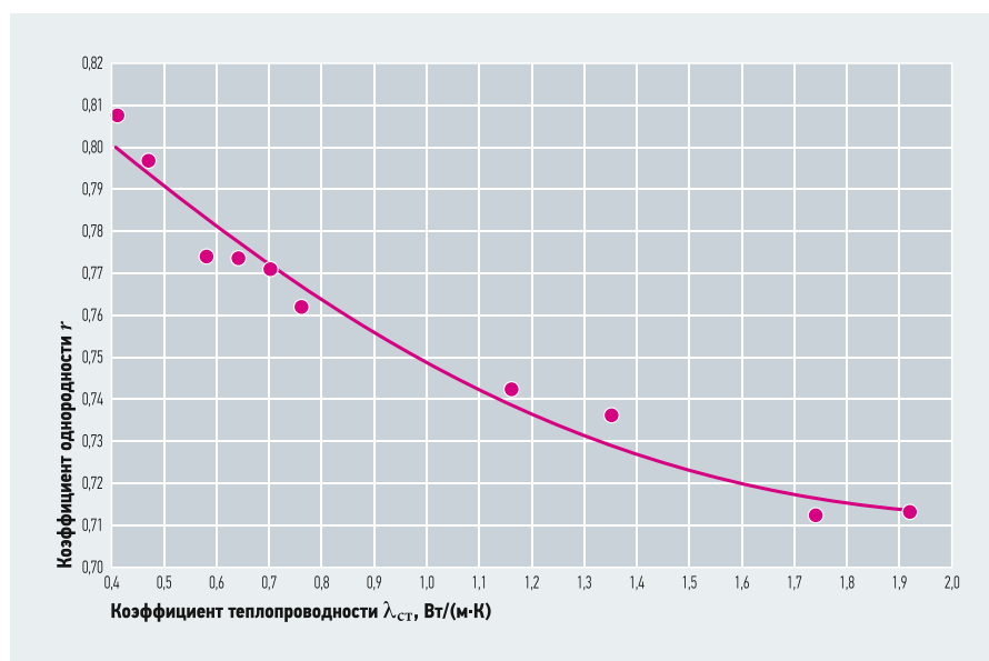
■ Рис. 2. То же, что на рис. 1, но с учётом только дубелей и оконных откосов
