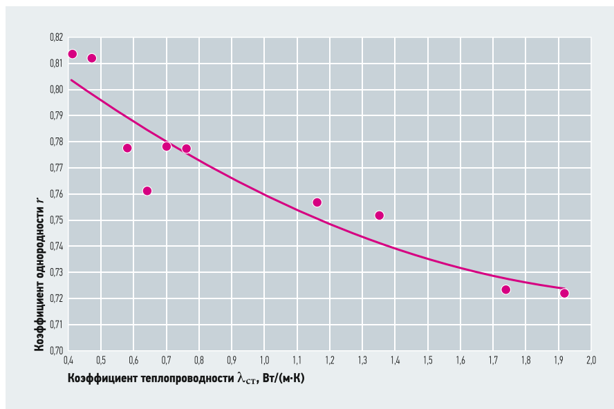
Рис. 1. Зависимость величины коэффициента однородности от коэффициента теплопроводности конструктивного слоя для наружной стены здания с учётом всех линейных элементов
