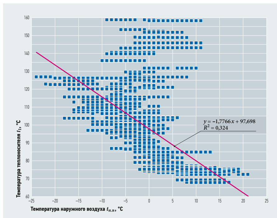
■ Рис. 3. Восстановленный температурный график зависимости температуры теплоносителя от температуры наружного воздуха
