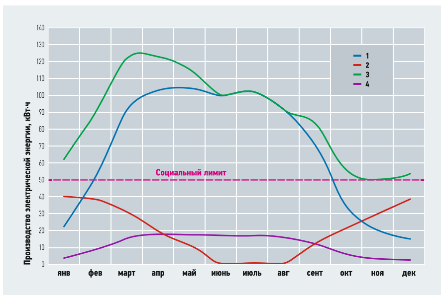
Рис. 4. Годовое производство электрической энергии комбинированной термофотоэлектрической установкой (1 — ФЭС с КПД = 15%, площадью 6 м 2 ; 2 — ТЭГС с КПД = 1%; 3 — общее производство ФЭС и ТЭГС; 4 — ФЭС с КПД = 15%, площадью 1 м 2 )
