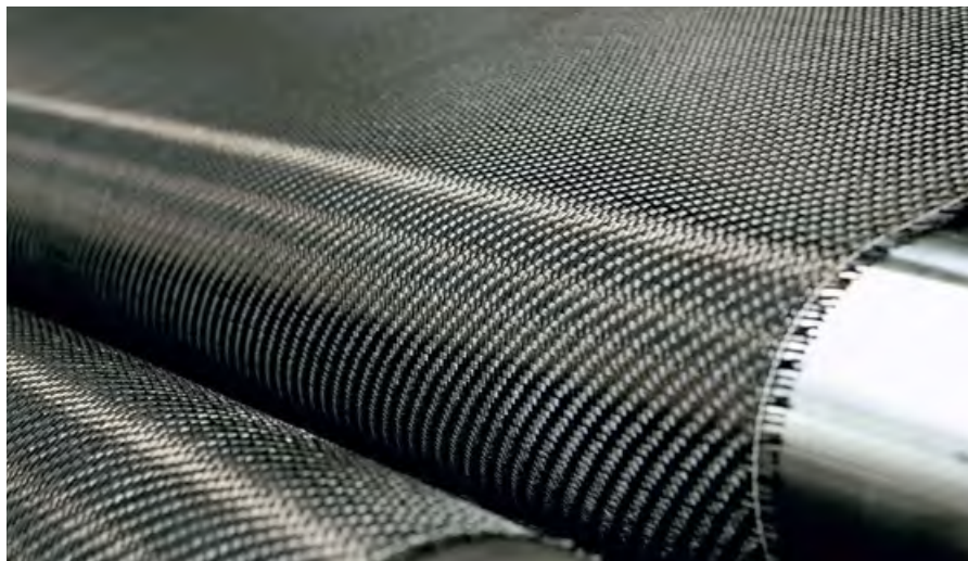
Композит CFRP — современный облегчённый и прочный материал
