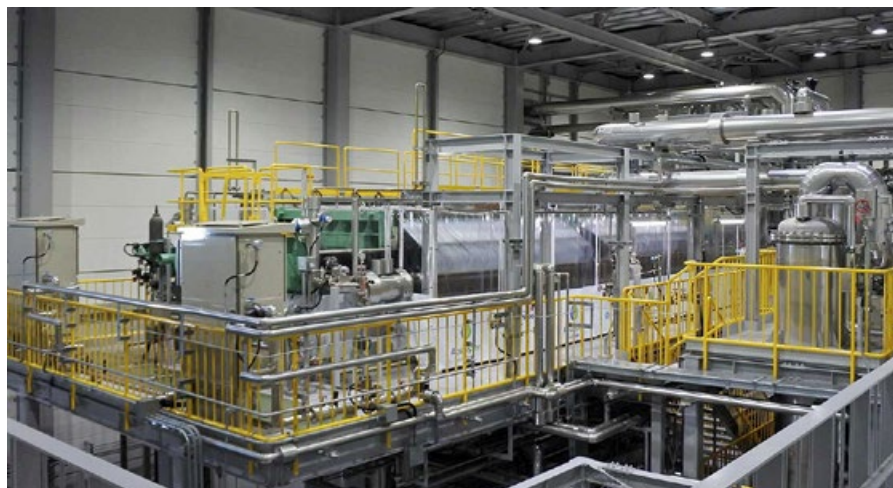
■ Установка водно-щелочного электролиза (10 МВт) компании Asahi Kasei на «Водородно-энергетическом исследовательском полигоне Фукусима» (г. Намие, Япония)
