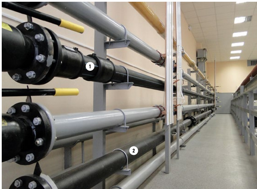
:: Фото 1. Крупногабаритный гидравлический стенд с пьезометрами и пятью трубами [1 — ПЭ-100 SDR 17 (110×6,6) по ГОСТ 18599–2001 условным диаметром 100 мм; 2 — труба ВЧШГ условным проходом 100 мм по ТУ 1461-037-50254094–2008]
