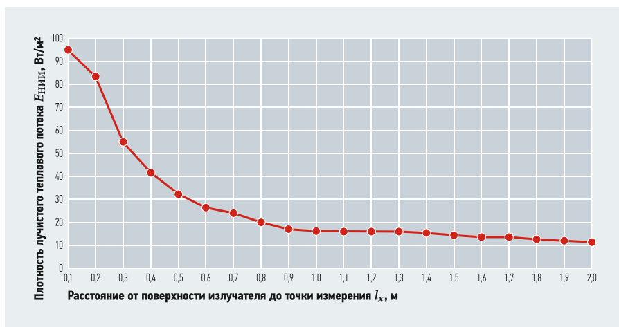
Рис. 7. График плотности лучистого потока излучателя Helios 750 в зависимости от расстояния до точки измерения
