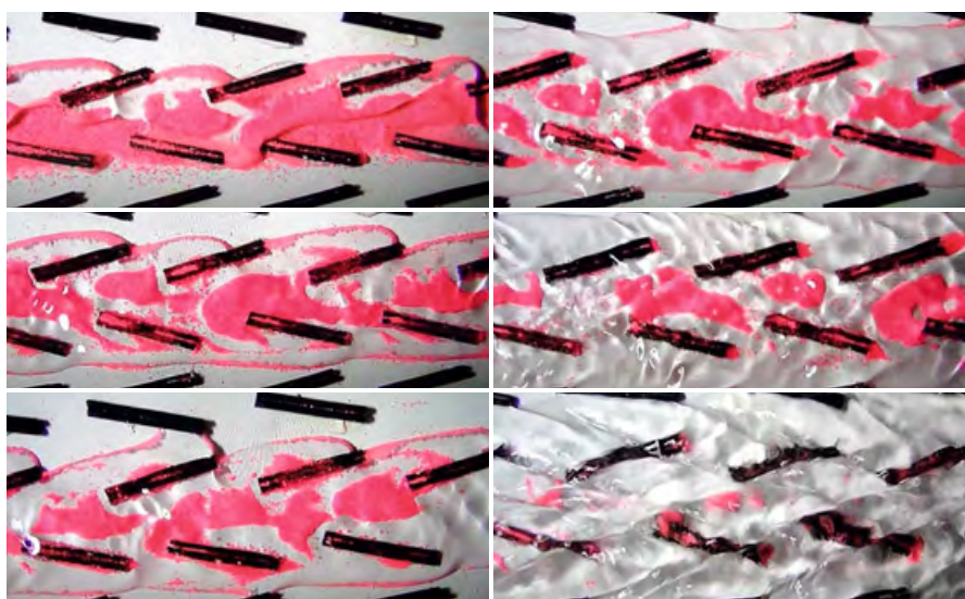
Рис. 4. Визуализация динамики выноса песчаных включений с текстурированной поверхностью в зависимости от скорости течения
