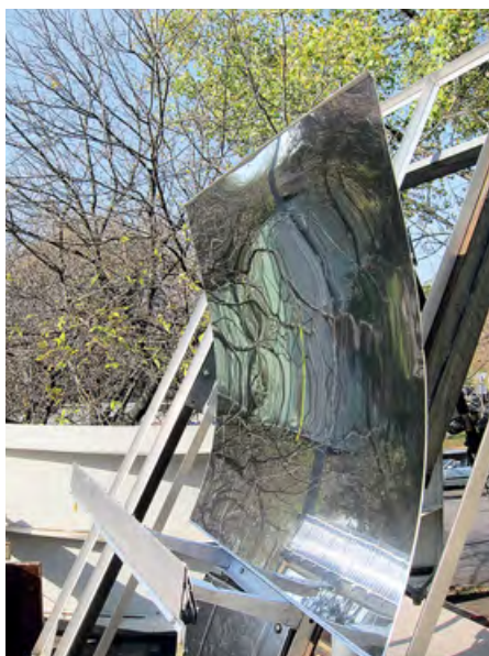
Рис. 1. Солнечная когенерационная установка на основе четырёх теплофотозлектрических модулей
