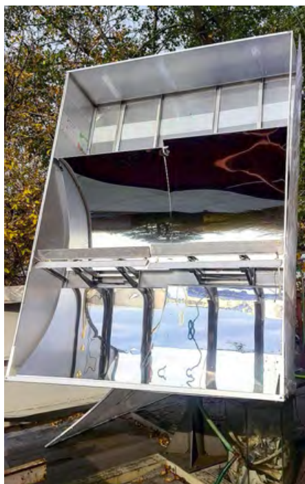
Рис. 1. Солнечная когенерационная установка на основе четырёх теплофотозлектрических модулей
