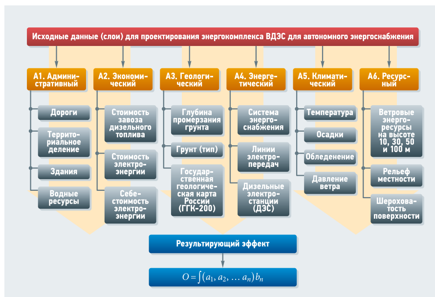
Рис. 2. Слои, необходимые для проектирования ветродизельных электростанций для северных условий ( O — целевой параметр, определяемый с учётом информации, представленной на слоях a_n , и весовых коэффициентов b_n )
