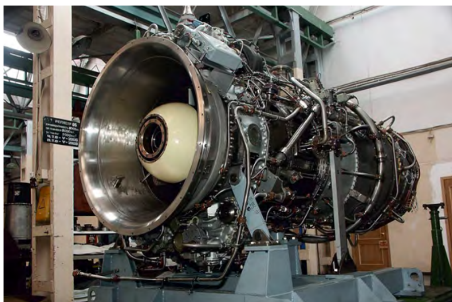
Пример ГТУ — газотурбинная электростанция «Урал-4000» на базе ГТУ-4П
