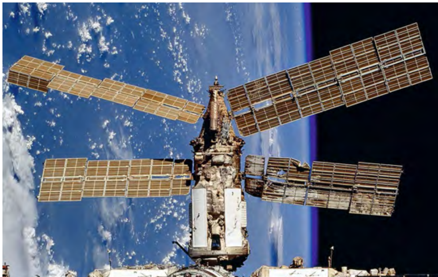
Энергообеспечение советской пилотируемой научно-исследовательской орбитальной станции «Мир», как и всех других космических аппаратов СССР, осуществлялось исключительно с помощью солнечных батарей разработки НПО «Квант». На фото представлен исследовательский модуль «Спектр», предназначенный для изучения атмосферы и геофизических явлений Земли, солнечные батареи которого имели размах 23,3 м (на модуле «Квант» их размах достигал 40,84 м)
