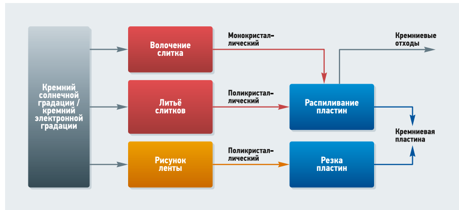
Рис. 2. Процесс производства солнечных элементов
