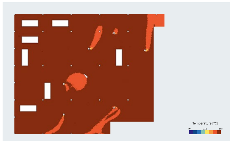
Рис. 2. Поле температур в горизонтальном сечении помещения
