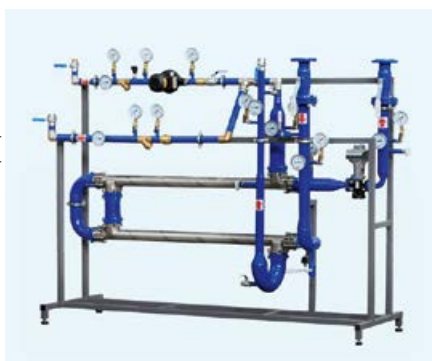
... Фото 2. БТП. Блок подключения системы ГВС к закрытым тепловым сетям по одноступенчатой схеме с кожухотрубным теплообменником
