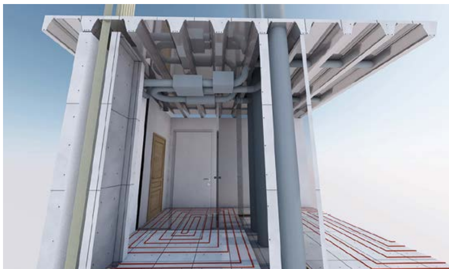
●● Типовой квартирный блок с инженерными системами
