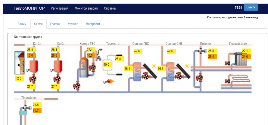
Рис. 5. Схема системы управления энергоэффективным домом в «ТеплоМОНИТОР»
