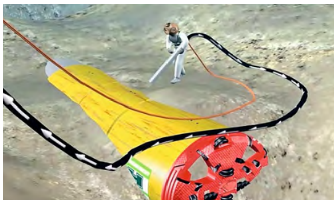
:: Рис. 8. Отсос оставшегося грунта дайвером в резервуар на барже
