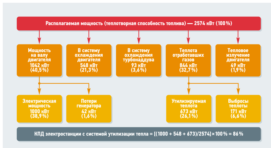
Рис. 2. Схема параметров работы дизель-генератора с системой утилизации теплоты
