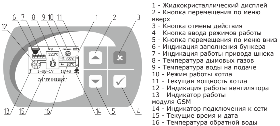
Рис.5. Расположение органов управления и индикации на передней панели пульта.
