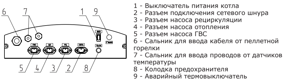
Рис.6. Расположение органов управления на задней панели пульта.
