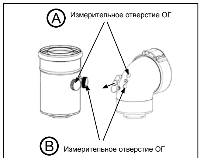
Измерение всасываемого воздуха и параметров ОГ для системы ОГ 60/100 при опциональном исполнении установки
