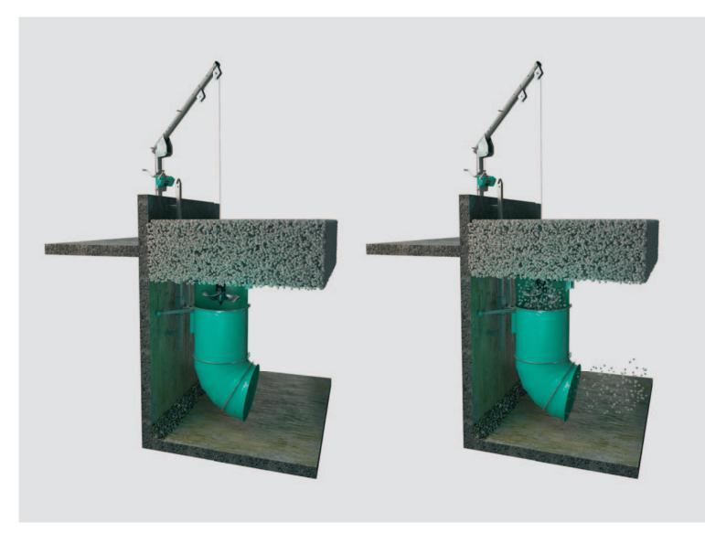
Плавающий слой из частиц-носителей биомассы: Частицы-носители, которые находятся в верхнем слое и выше сточной воды, не участвуют в процессе биологической очистки.
