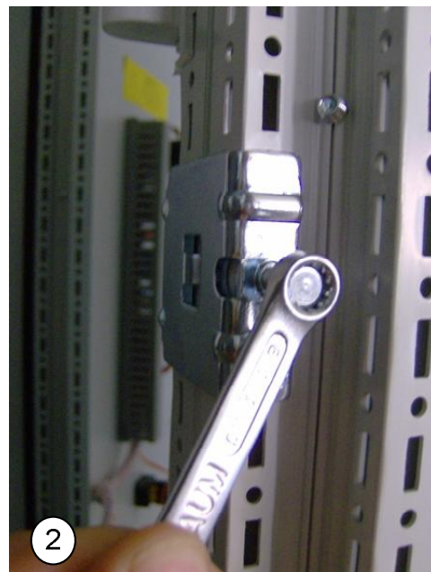
Монтаж стягивающего соединителя на вертикальных профилях шкафа
