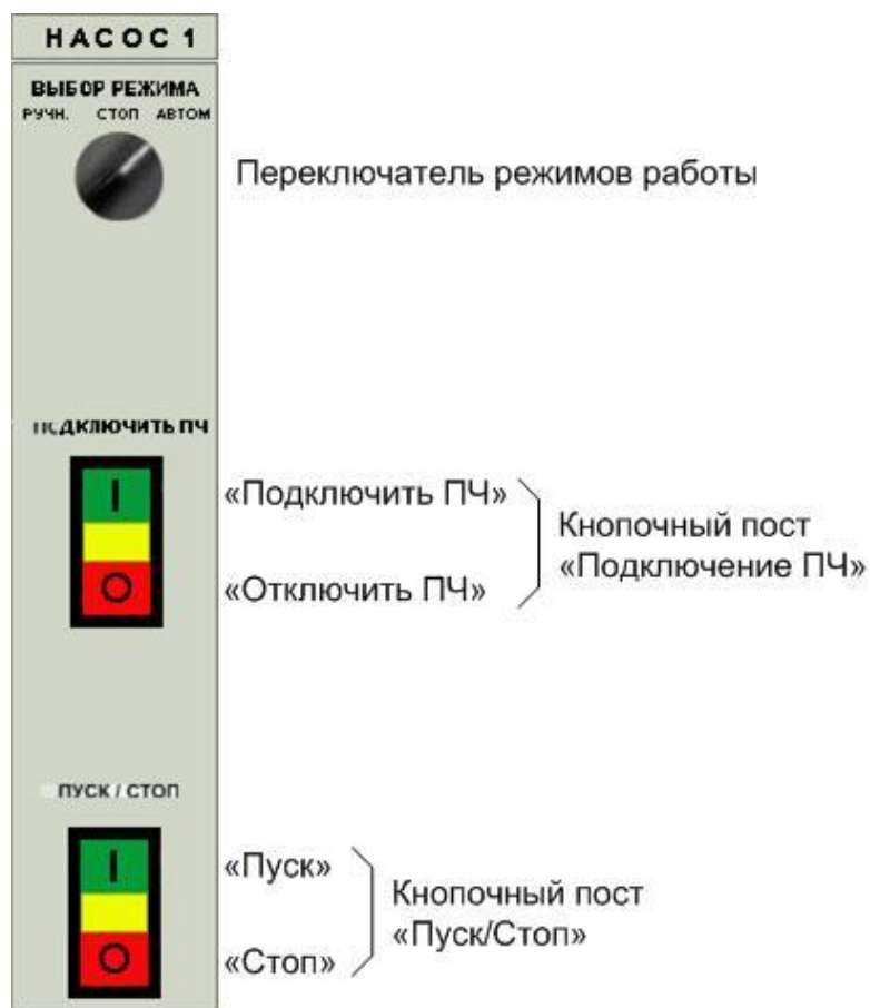
Рис. 6. Пост ручного управления насосом с возможностью подключения к преобразователю частоты.
