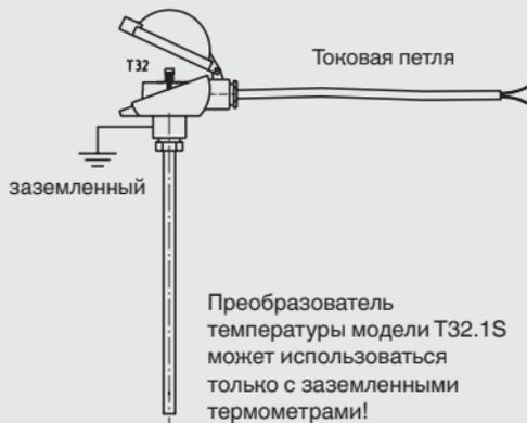
Термопары дополнительно заземлить здесь!
