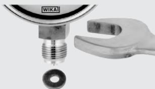
Правильное уплотнение соединений манометров с параллельной резьбой ① выполняется с помощью соответствующих уплотнительных колец, уплотнительных шайб или сальниковых уплотнений WIKA. Уплотнение конической резьбы (например, нормальная трубная резьба) выполняется посредством обеспечения на резьбе ② дополнительного уплотнительного материала, например тефлоновой ленты (EN 837-2).
