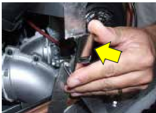
- Удалить фиксирующую пружину камеры вентиляторов (сторона правая/левая).
