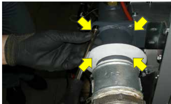
- Достаньте четыре винта при помощи торцевого ключа 10 мм, а затем фланец газа
