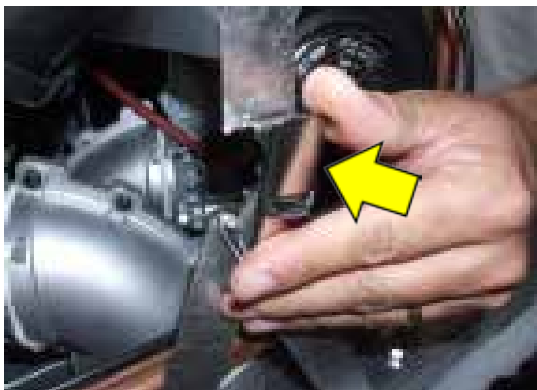
- Удалить фиксирующую пружину камеры вентиляторов (сторона правая/левая).
