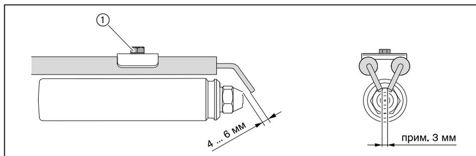
9.6.2 Настройка электрода зажигания на опорной шайбе
