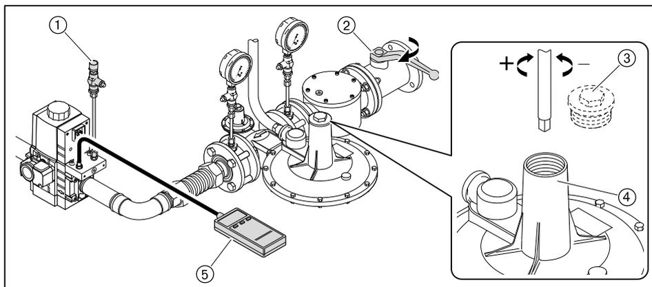
Предварительная настройка давления на регуляторе низкого давления
