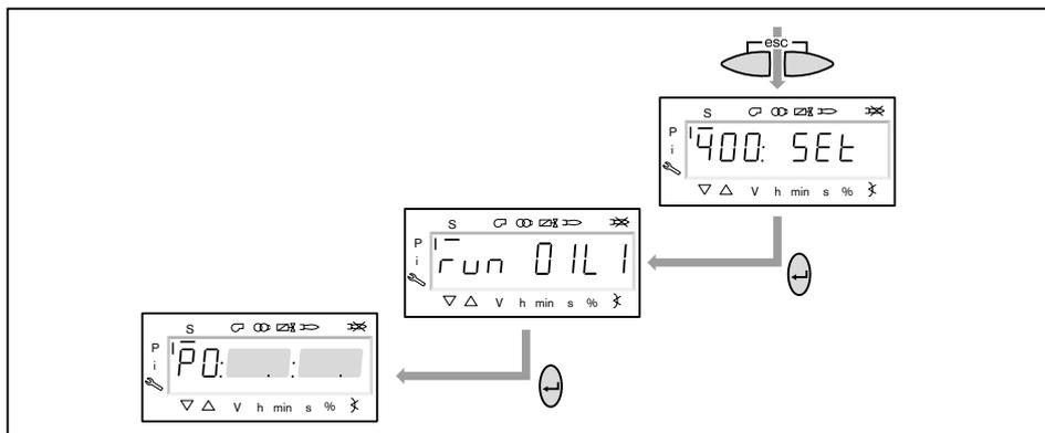
11. Проверка давления смешивания в положении зажигания
