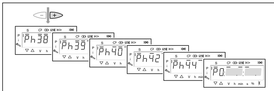
13. Корректировка давления настройки на регуляторе давления
