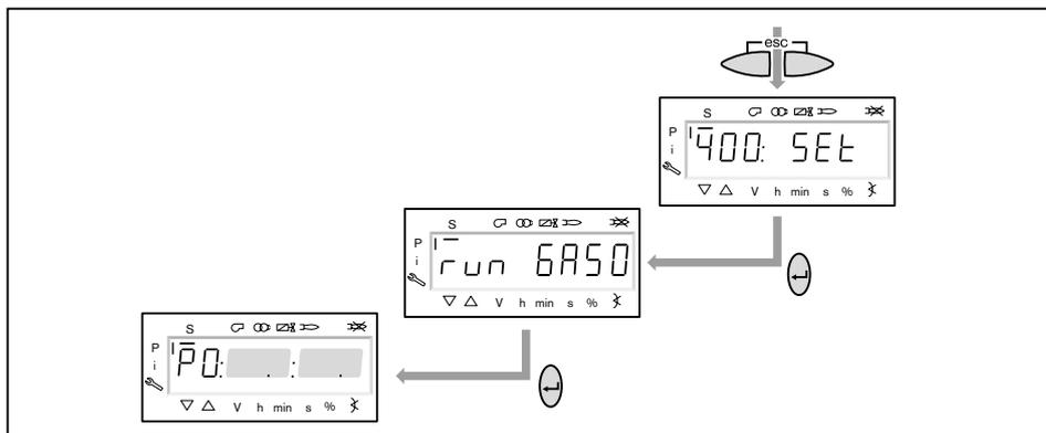
10. Проверка давления смешивания в положении зажигания
