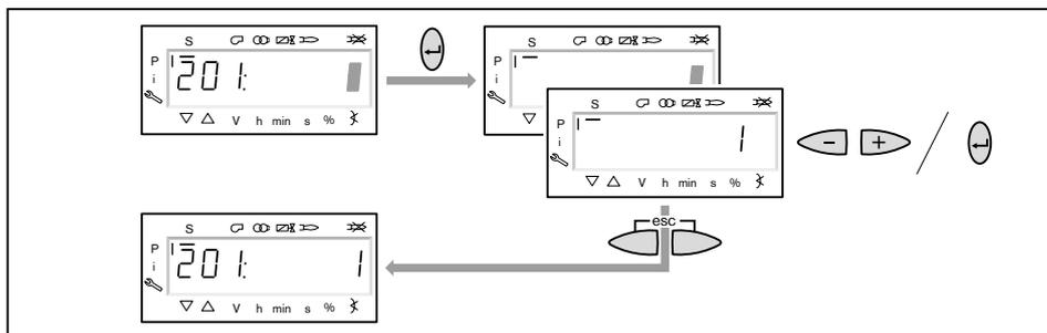
5. Включение / отключение частотного преобразователя
