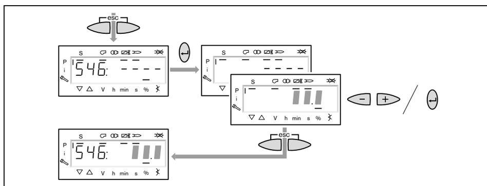
21. Определение нижнего предела мощности (малой нагрузки)
