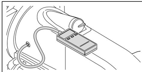
Манометры для жидкого топлива подключить к топливному насосу
