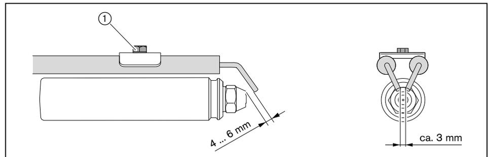
9.7.2 Настройка электрода зажигания на опорной шайбе
