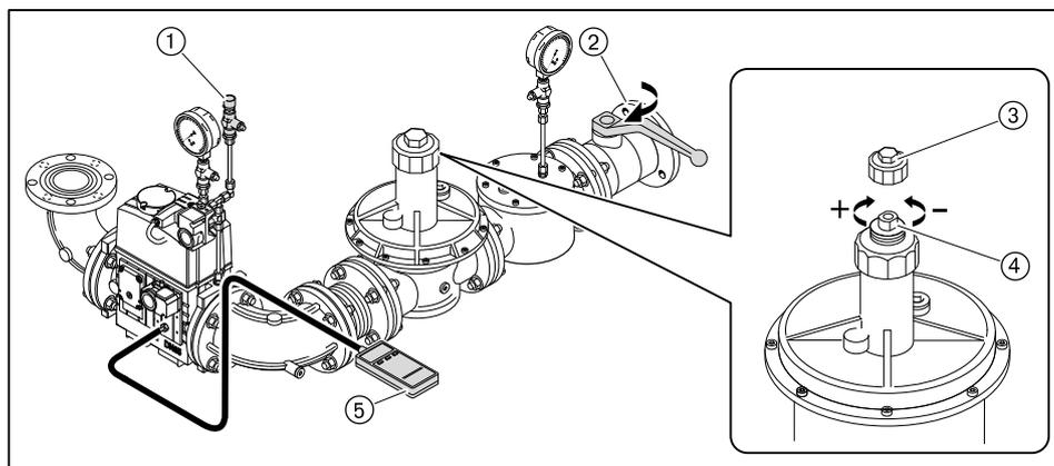
**7.1.8 Предварительная настройка реле давления газа и воздуха**
