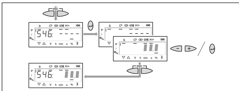
**21. Определение нижнего предела мощности (малой нагрузки)**
