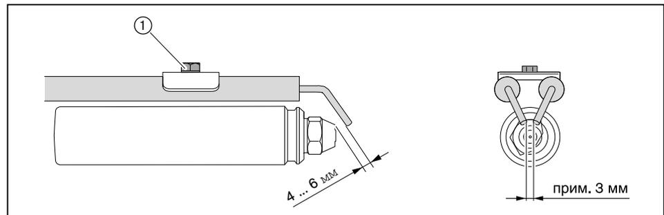
9.7.2 Настройка электрода зажигания на опорной шайбе
