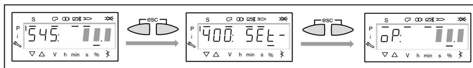
**23. Корректировка положения воздушной заслонки на предварительной продувке**
