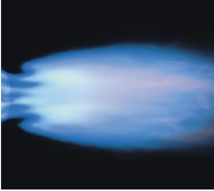
Типичный факел горелки исполнения LowNO x
