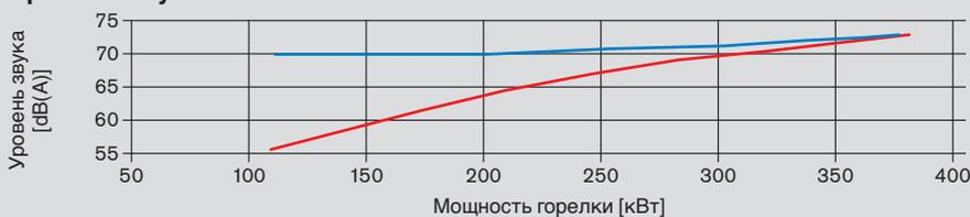
— WG40 — WG40 с частотным регулированием
