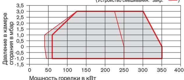
Тип горелки **WG30F/1-C, исп. ZM-LN**
