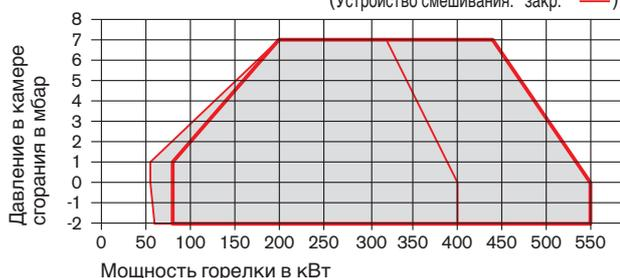
Тип горелки **WG40F/1-A, исп. ZM-LN**
