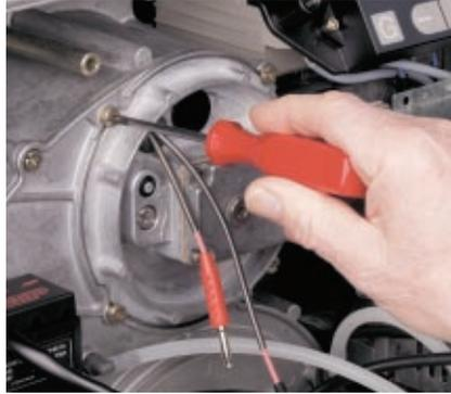
Отвинчивание устройства смешивания
