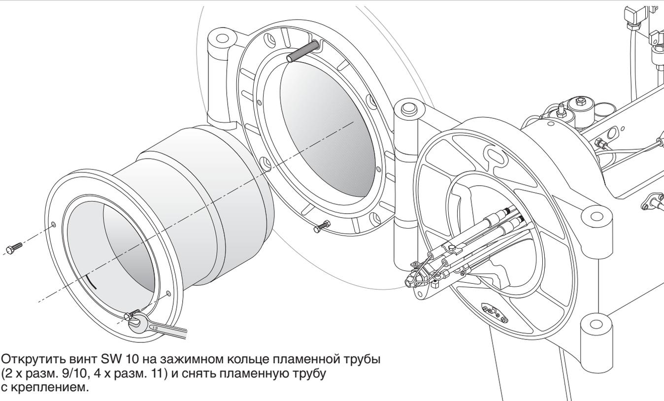
Открутить винт SW 10 на зажимном кольце пламенной трубы (2 x разм. 9/10, 4 x разм. 11) и снять пламенную трубу с креплением.
