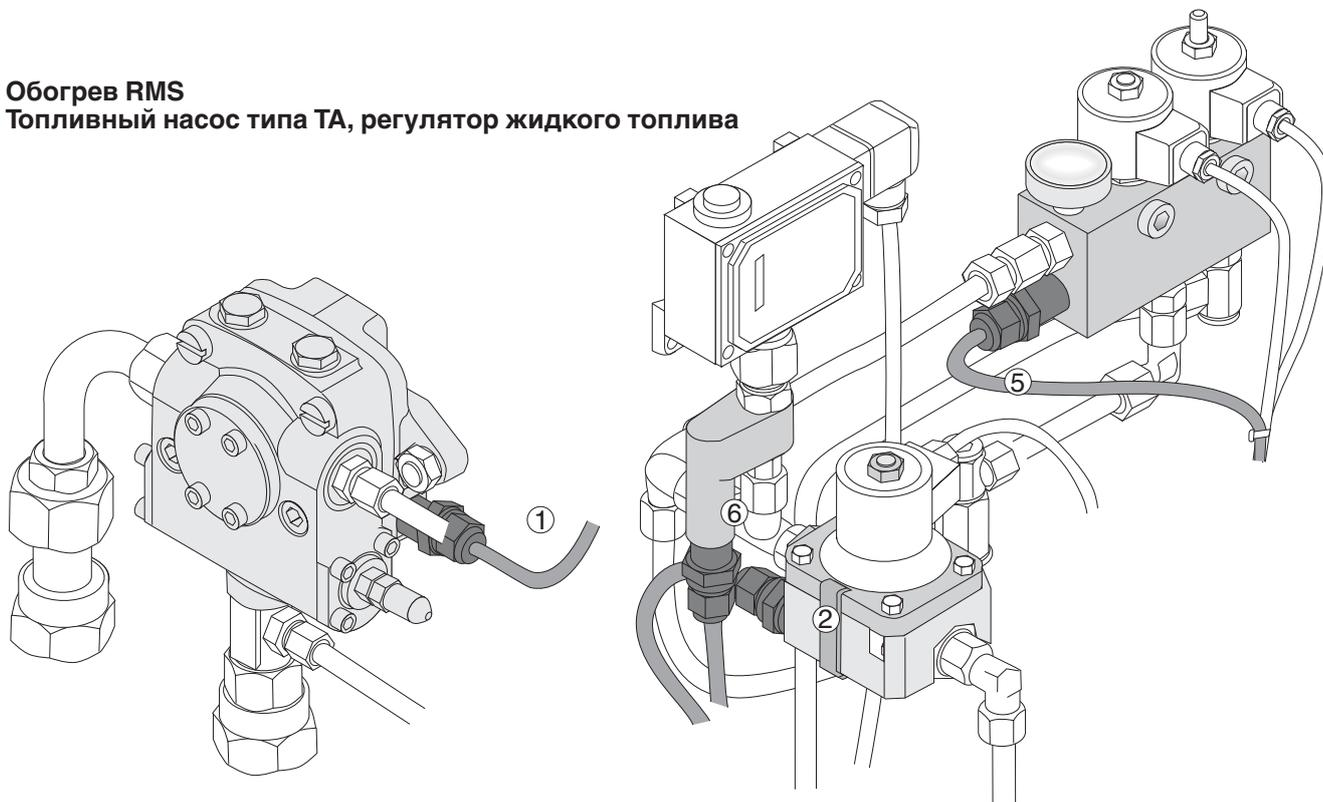
По окончании работ по техническому обслуживанию горелки включить горелку и проверить функциональность обогрева арматуры (нагревательные патроны) при помощи накладного термометра на следующих блоках:
