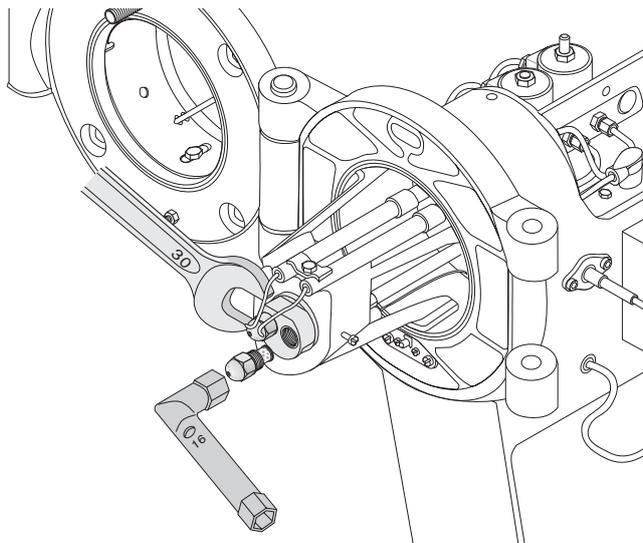
Выкрутить форсунку SW16, удерживать ключом SW 30 для противоупора.
