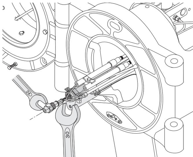
Выкрутить форсунку с обратной линией ключом SW 24, удерживать ключом SW 30 для противоупора.
