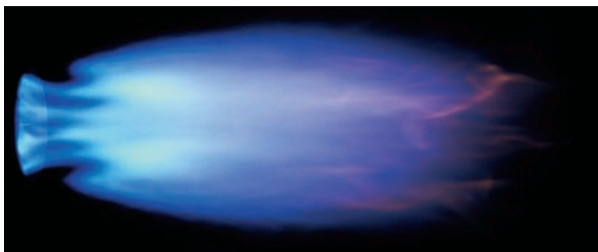
Пламя горелки при исполнении с пониженным содержанием NOx в дымовых газах
