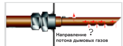
Устройство для забора пробы дымовых газов
